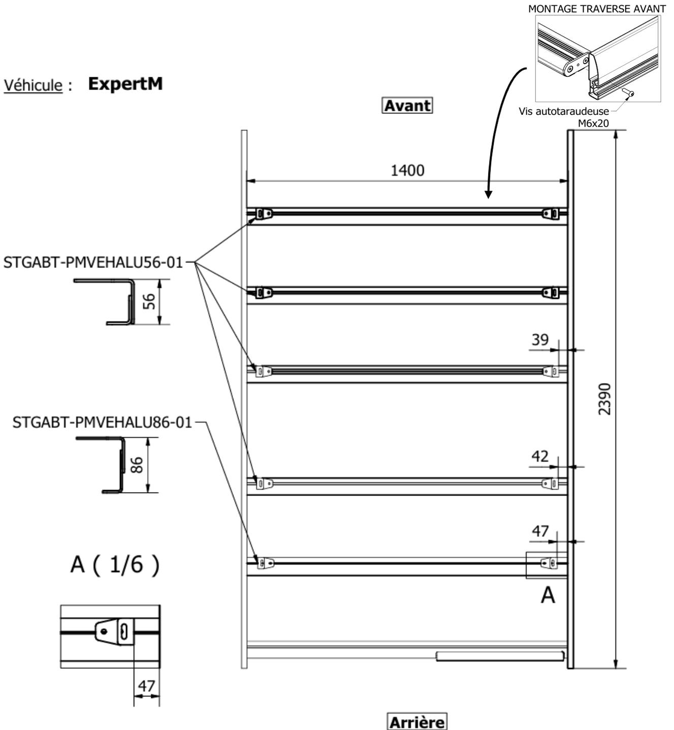
Positionnement des fixations sur les traverses de la galerie.
