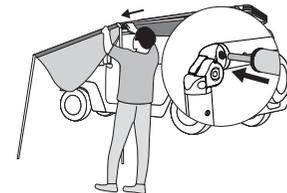
5 - Insérez le piton des mâts de chaque côté dans les trous prévus sur le poteau vertical.
