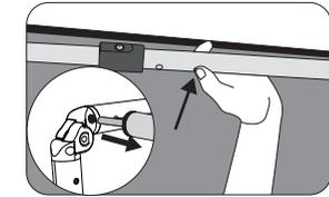
3 - Pressez le bitonniau sur chaque mât, afin de les désolidariser des poteaux verticaux.
