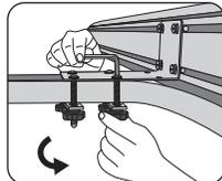
2 - Ajustez l'espacement des supports en L pour qu'ils soient en face des deux barres de toit ou de la galerie. Passez les vis longues à travers les supports en L et fixez-les solidement aux barres de toit aux positions indiquées. (Installez-les à fleur des barres de toit ou de la galerie, et aux positions A et B indiquées sur l'image ci-dessus).
