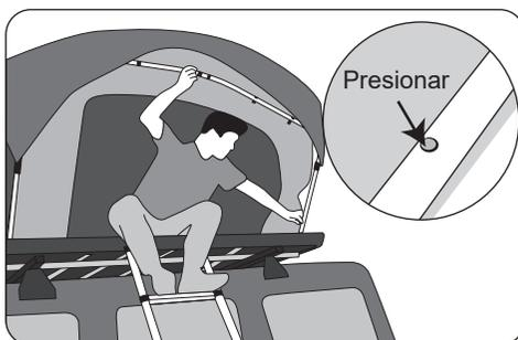
3. Fermez toutes les fenêtres, fermez la porte avant à moitié et laissez la moitié pour l'échappement (voir la figure ①), fermez les poches à chaussures des deux côtés (voir la figure ②), puis appuyez sur le couvercle de la tente, pendant la descente, rangez les deux côtés de la toile de tente vers l'intérieur pour que la toile ne soit pas exposée.
