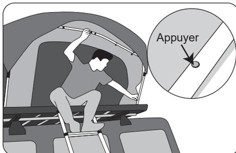
5. Ouvrez la fermeture éclair supérieure, étirez la tige de support supérieure vers l'avant et verrouillez la boucle de la plaque, et faites de même dans l'autre section.
