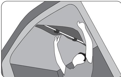
2. Appuyez tour à tour sur les deux côtés de la tige de support, rétractez la tige de support avant vers l'intérieur.
