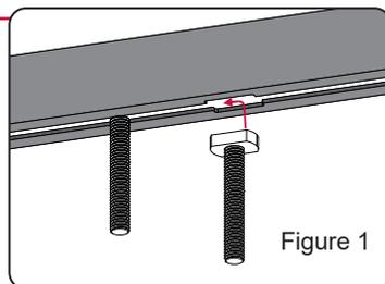
4. Passez le boulon en T à travers la pièce de fixation en forme de U, mettez la rondelle élastique et la rondelle plate, vissez l'écrou torx, puis faites-le glisser depuis la fente centrale. Selon la taille du porte-bagages, vous pouvez choisir d'installer la pièce de montage en forme de U directement ou à l'envers. **Remarque : utilisez une vis de type T M8 x 50 mm pour une installation formelle et une vis de type T M8 x 70 mm pour une installation inversée.**
