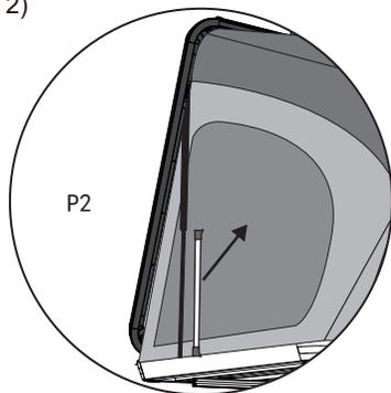
\* Il s'agit d'une solution d'urgence pour éviter que le toit ne s'effondre en cas de pression insuffisante des ressorts à gaz, et cela prolongera également la durée de vie des ressorts à gaz.
