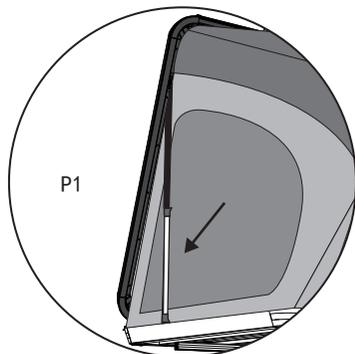
Avant de replier la tente, retirez les deux tiges de verrouillage de rechange des ressorts à gaz. (Comme indiqué dans la figure 2)
