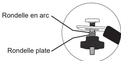
5. Vissez l'autre côté du stator en forme de U avec le composant dans l'ordre indiqué ci-dessus, et assurez-vous que le stator est serré (comme indiqué à la figure 3, même opération pour le reste).
