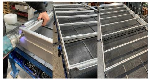
Positionner les longerons sur les vis glissées au préalable dans les traverses. Puis placer les écrous sur ces dernières sans les serrer.
