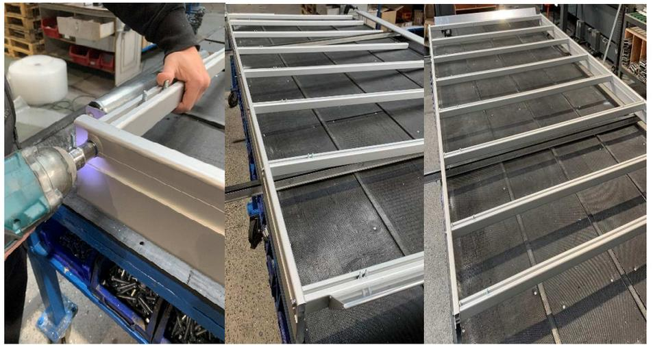
Positionner les longerons sur les vis glissées au préalable dans les traverses. Puis placer les écrous sur ces dernières sans les serrer.
