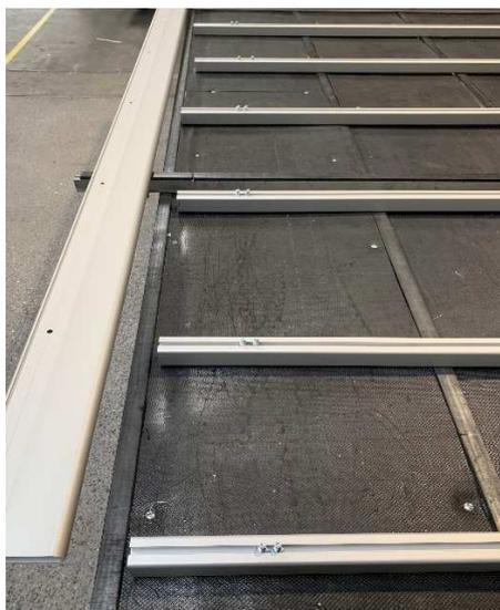
Préparer les vis qui viendront fixer les lisses aux traverses (vis 8x40 + rondelle Grower + rondelle)
