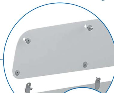
Pour les éléments à fixer sur la partie supérieure et basse de la porte, utiliser les agrafes en plastique. Il existe différents modèles d'agrafes.
