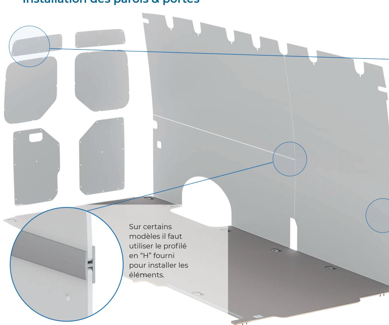
Sur certains modèles il faut utiliser le profilé en "H" fourni pour installer les éléments.
